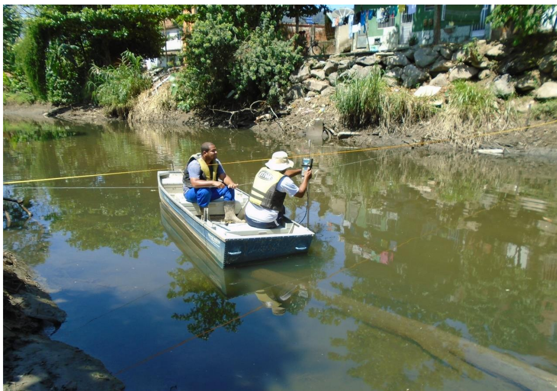
Figura 3.4 - Medição de vazão com RiverRay no Rio do Meio.
