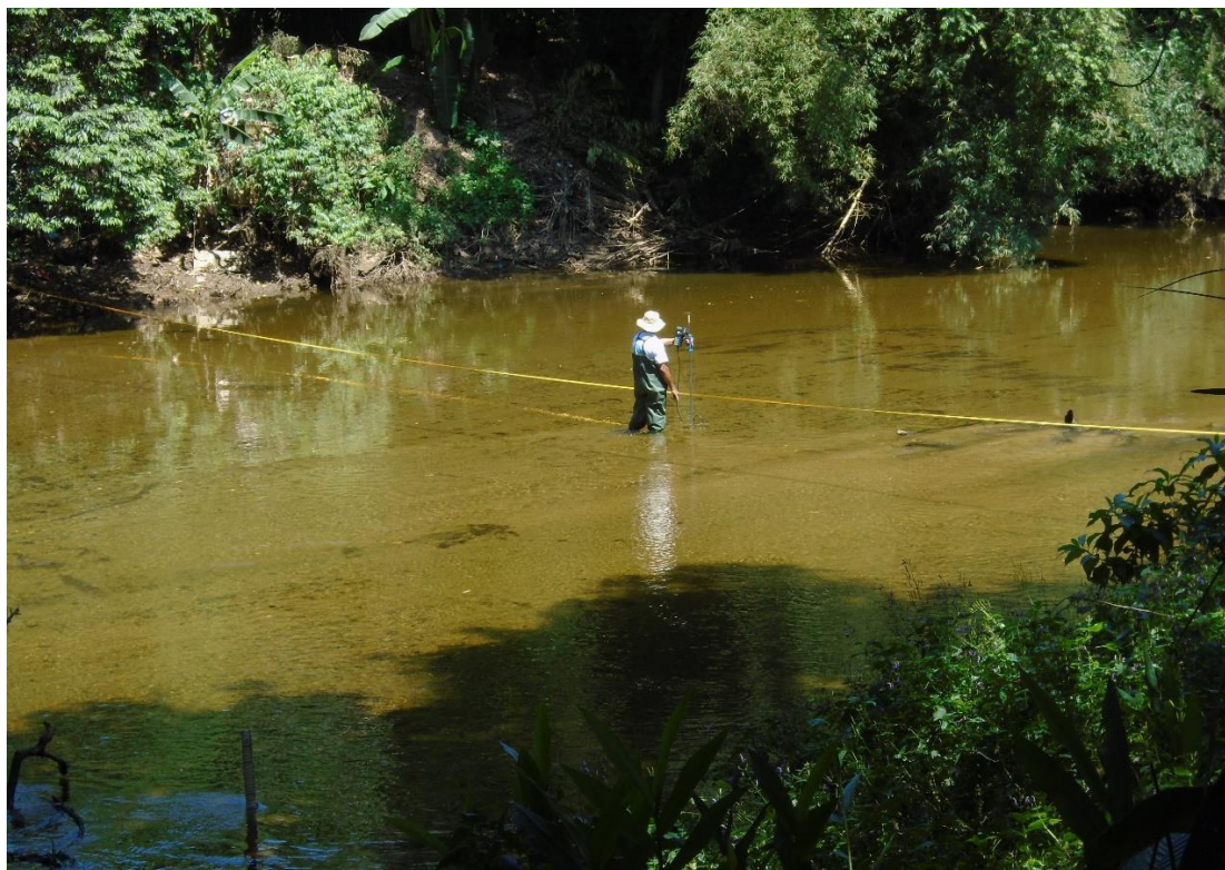
Figura 3.3 - Medição de vazão com Flowtracker no Rio Bracuí.
